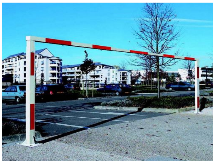
Portique fixe réglable en largeur de passage
